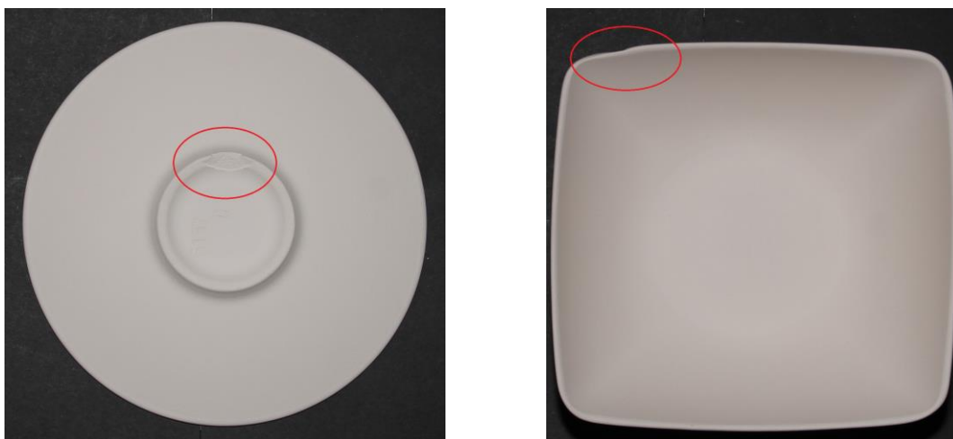
Figura 3: Defectele întâlnite pe suprafața farfuriilor
