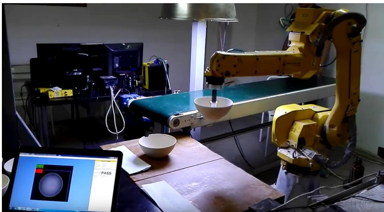
Figura 2: Modul de funcționare a sistemului optimizat pentru inspecția farfuriilor.
