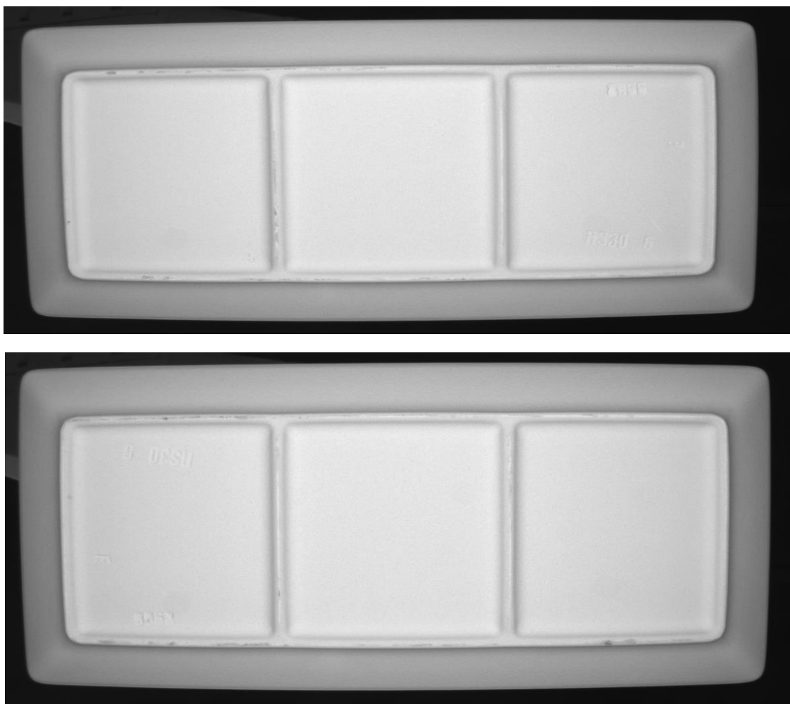
Figura 1: Imagini analizate pentru recunoașterea caracterelor ștanțate pe farfurie.
